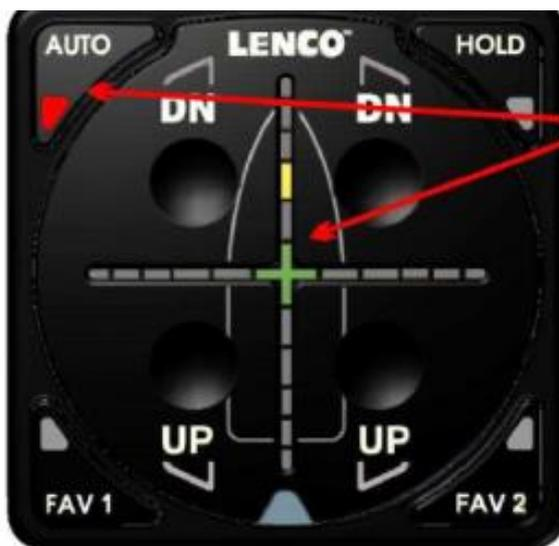
Die AUTO-LED leuchtet auf, sobald das System sämtliche Daten erfasst hat, die für den Automatik-Betrieb erforderlich sind.
