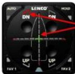
Das System wechselt in den LIMP-HOME Modus. Der StB-Antrieb lässt sich jedoch nicht weiter ausfahren, sondern nur noch einfahren.
