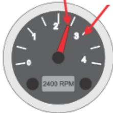
**Bild 5.3.2: Dieselmotor = 80% der max. UpM**
