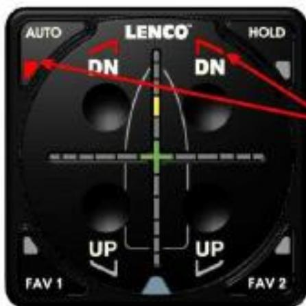
Drücken der AUTO-Taste (bei der die LED leuchtet) schaltet in den normalen ‚Hole-shot‘ Modus um. – Die Trimmklappen fahren vollständig aus (auch wenn der Rauwasser-Zustand erfasst ist).
