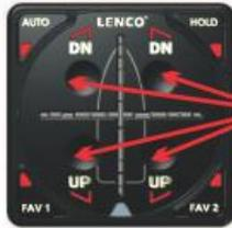
Um den Test-Modus zu verlassen, alle vier UP/DN Tasten eine Sekunden lang drücken.
