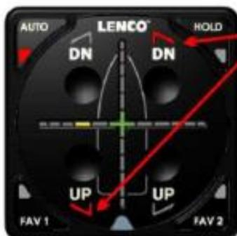
Nach jeder Trimmklappen-Bewegung zeigt das Fadenkreuz die veränderte Boots-lage in der LED-Querleiste an.
