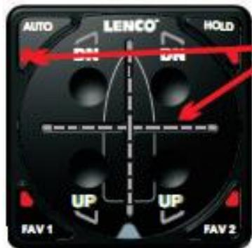
Nach Loslassen der der AUTO-Taste wird die AUTO-LED dreimal blinken, womit die Speicherung der neuen Boots-lage bestätigt wird. Auch die wandernde Fadenkreuz-Anzeige schaltet ab. Damit hat das System zurück in den Test-Modus geschaltet.
