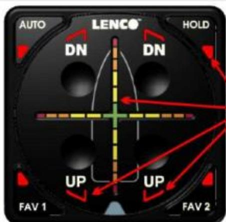
*Werden die erforderlichen Daten wieder empfangen, erfolgt ein Blinken der vier AUTO-LEDS und sämtlicher Fadenkreuz LEDs.*
