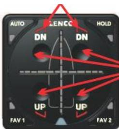
In STANDBY den Test-Modus aktivieren. Hierfür alle vier UP/DN Tasten 4 Sekunden lang gedrückt halten.
