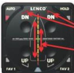
Während der Kalibrierung blinken die DN-Tasten mehrfach kurz auf und zeigen damit an, dass die Trimmklappen verstellt werden.
