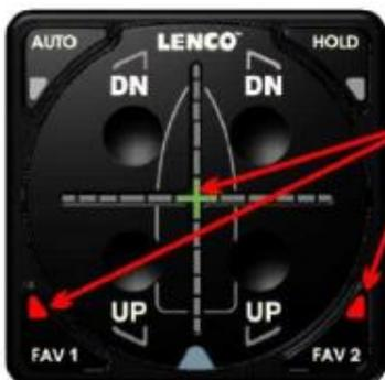
Im Fadenkreuz leuchtet in diesem Zustand die grüne Kreuz-LED und zeigt damit an, dass diese aktuelle Boots-lage die gewünschte Boots-lage ist, zu der hin das AUTO GLIDE laufend korrigiert.
