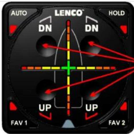
*Eine der vier UP/DN-Tasten drücken, um die Trimmklappenbewegung zu stoppen und direkt in den LIMP HOME Modus wechseln..*
