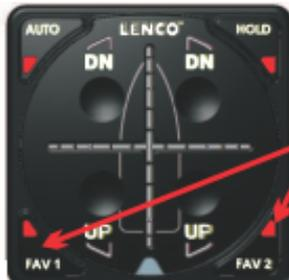
Im Test-Modus muss entweder FAV1 oder FAV2 gedrückt werden, um den DATA VERIFICATION MODUS aufzurufen.
