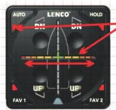
Sobald die AUTO LEDs das Blinken stoppen und die LEDs der Horizontal-Linie hin und her wandern, ist die neue Home-Roll Kalibrierung möglich. Nach Löschen der Speicherwerte müssen entsprechend neue Werte erfasst werden, bevor der Test-Modus verlassen wird.
