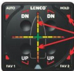
Nach dem 4-Sekunden langen Drücken der UP/DN-Tasten leuchten die 4 Auto-Setting LEDs auf. Die Kreuzhaar LEDs leuchten auf und schalten zur Mitte hin nacheinander ab.
