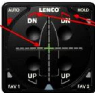
Um eine aktuelle Gleitwinkel-Veränderung zu korrigieren, bewegt das *AUTO GLIDE* die Trimmklappen gleichzeitig parallel nach oben bzw. nach unten. Dadurch wird vermieden, dass sich die Verstellung auch auf den Roll-Winkel auswirkt.
