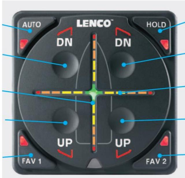
**HOLD** – kurz drücken. Damit wird die aktuelle Klappen-Einstellung als Basis-Nullstellung aktiviert und temporär gespeichert.
