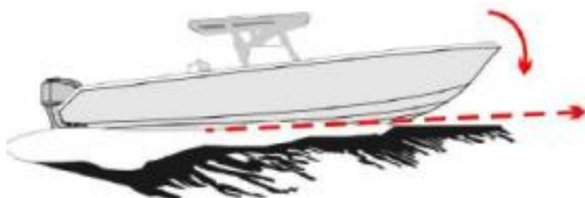
Um eine aktuelle Gleitwinkel-Veränderung zu korrigieren, bewegt das *AUTO GLIDE* die Trimmklappen in kleinen Schritten gleichzeitig parallel nach oben bzw. nach unten, bis das Boot die Basis-Lage für ökonomische Gleitfahrt erreicht hat.
