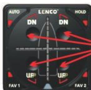
Um den Testmodus zu verlassen, alle vier UP/DN-Tasten gleichzeitig eine Sekunde lang drücken.
