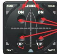
Im Test\_Modus sind alle 4 (UP/DN) LED-Anzeigen aktiviert.
