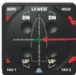
Werden keine GPS- oder Motoren-Daten empfangen, leuchtet nur das grüne Fadenkreuz
