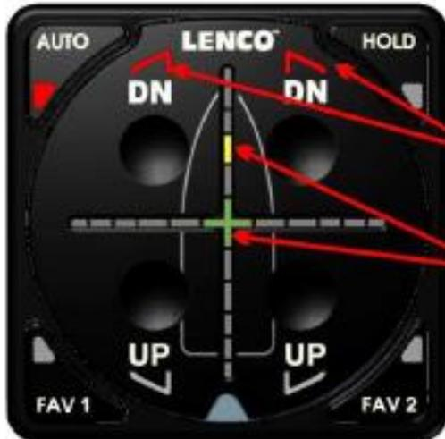
Durch Drücken der AUTO-Taste werden die Trimmklappen bis zum Anschlag ausgefahren. (Die Bedingungen für Rauwasser-Verhältnisse werden auf Seite 12 beschrieben.)
