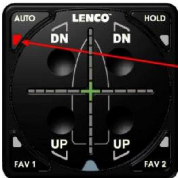
Drücken von einer der Automatik-Tasten schaltet das System unverzüglich in den entsprechenden Modus um.
