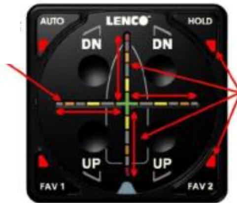
Bei automatischer Daten-Wiederkehr blinken sämtliche vier AUTO Leds und alle vier Quadranten vom Fadenkreuz.
