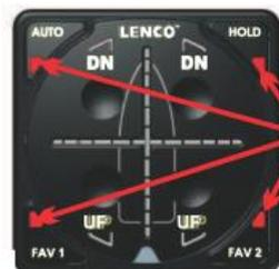
Sobald der Testmodus aktiviert ist, wechseln die vier blinkenden LEDs in den Ecken auf Dauerlicht um.
