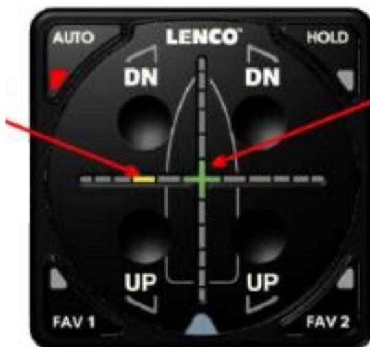
Da der aktuelle Gleitwinkel (Vorauswinkel) der Basiseinstellung entspricht, verbleibt hierfür die grüne Fadenkreuz-LED leuchtend.
