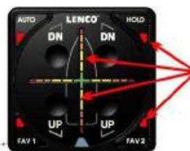
Wird ein Pitch- und Roll- Fehler für länger als 10 Sekunden gemessen, erfolgt eine entsprechende Alarm-Anzeige. Alle vier Auto-LEDs blinken, und es erscheint auf allen Fadenkreuz-Linien eine wandemde LED-Anzeige.
