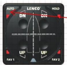
Ist der Test-Modus aktiviert, die AUTO-Taste drücken und gedrückt halten, bis die AUTO-LED 3 mal blinkt. Damit wird bestätigt, dass die Roll und Pitch Speicherwerte gelöscht sind
