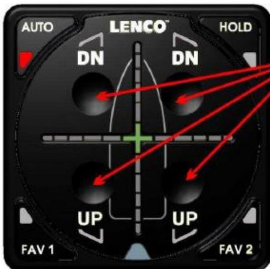
*Drücken einer beliebigen UP-/DN-Taste schaltet in den manuellen Betriebsmodus um.*
