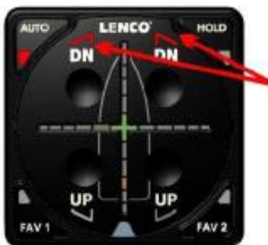
Bei einem Manöver werden die Trimmklappen ausgefahren. Dabei wird für den StB-Antrieb ein zu hoher Strom gemessen.
