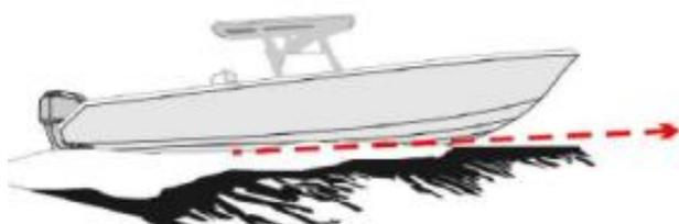
Sobald der aktuelle Gleitwinkel dem vorjustierten Basiswert entspricht, erfolgen keine Korrekturbefehle für den Gleitwinkel mehr.
