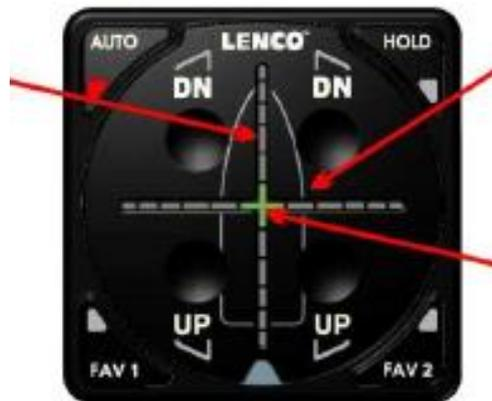
Die horizontalen Fadenkreuz LEDs zeigen die aktuelle Boots-Querlage (Roll) in Relation zur voreingestellten Soll-Winkellage für ökonomische Fahrt an
