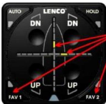
Sobald im manuellen Modus für den aktuellen Fahrzustand die benötigten Trimm-Einstellungen gefunden sind, die FAV1 oder FAV2 Taste drücken und halten, bis die entsprechende LED fünfmal blinkt.
