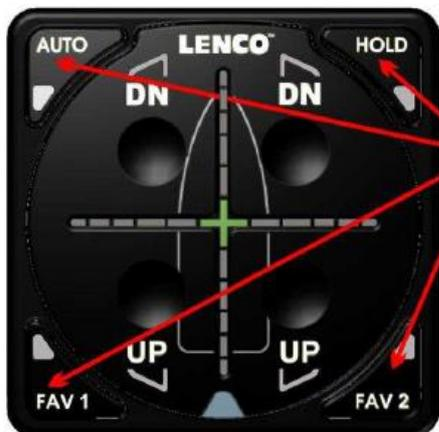
Eine der vier Automatik-Tasten drücken, um den manuellen Modus zu verlassen.
