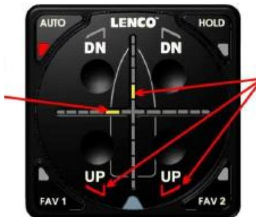
Die Trimmklappen werden Schritt für Schritt eingefahren, bis die Boots-lage für ökonomische Fahrt erreicht ist.
