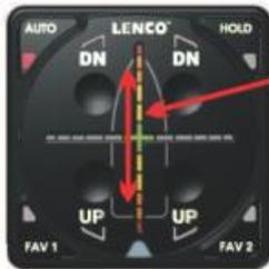
Die vertikale LED-Linie wird aktiviert und wandert von oben nach unten, um anzuzeigen, dass der Pitch-Justiermodus (Auf- und Ab-Bewegung in der Vorausrichtung) aktiviert ist.
