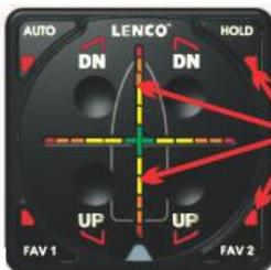
Ist der Test-Modus aktiviert, leuchten die 4 LEDs in den Ecken.
