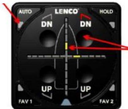
*Mit den UP/DN-Tasten den optimalen Gleitwinkel finden und die Seitenkrängung minimieren. – Gleichzeitig durch Vergleich mit den Fadenkreuzanzeigen eine optimale Querlage finden.*
