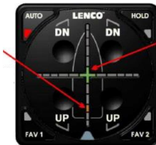
Der aktuell anliegende Rollwinkel ist korrekt und entspricht dem vorjustierten Basiswert.
