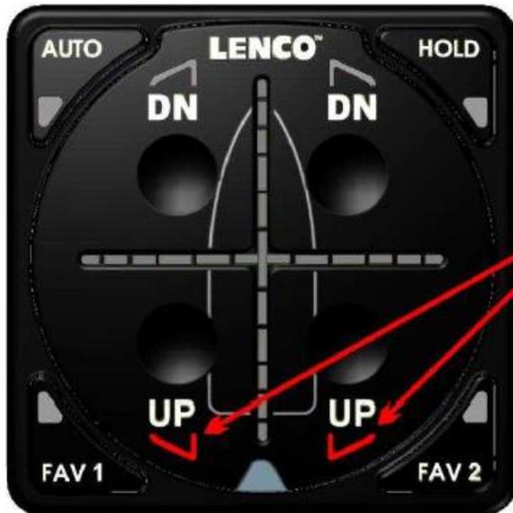
Die UP-LEDs blinken und zeigen damit an, dass die Trimmklappen völlig eingefahren werden.
