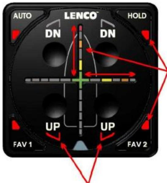
Bei einem Ausfall von Motordaten blinken die 4 „Auto“-Tasten LEDs, und die Fadenkreuz-LEDs wandern von der Kreuzmitte nach außen in die 12-Uhr Position sowie von der Mitte zur 3-Uhr Position
