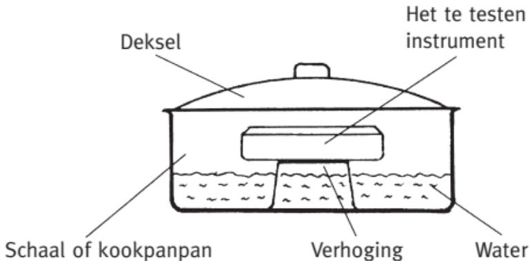
Direkt na het openen van de deksel stelt men de wijzer op 95 % relatieve vochtigheid in. Dit doet men door middel van de instelschroef aan de achterzijde van het instrument met een kleine schroevendraaier te verstellen.
