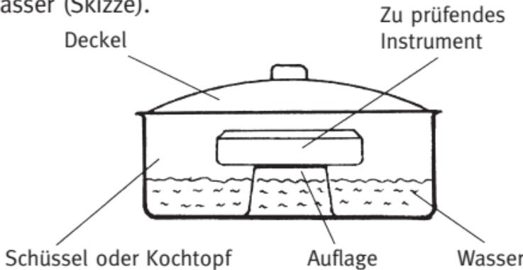
Unmittelbar nach dem Öffnen des Deckels stellt man den Zeiger auf 95 % rel. Feuchte ein. Dies geschieht durch Drehen eines Einstellschlitzes mit einem kleinen
