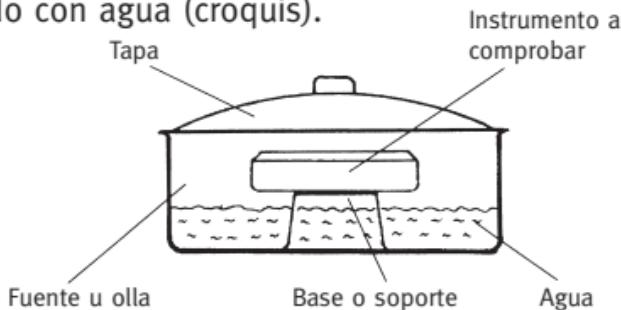
Directamente después de abrir la tapa, la manilla se pone a 95 % de humedad relativa. Ello se realiza girando en la parte trasera de la caja una ranura de ajuste con un pequeño destornillador. Después de transcurrir un poco de tiempo, el higrómetro se ajusta de nuevo autónomamente al valor correcto del lugar de aplicación. La exactitud de indicación de los higrómetros se encuentra entre 3 y 5 % y está en función de la conservación (regeneración).
