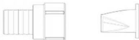
Recuerde que la válvula de retención NO debe usarse con el empalme de codo. La combinación de válvula de retención y codo restringen notablemente el caudal.
