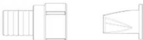
Let op: de regelklep mag NIET gebruikt worden in combinatie met een elleboogfitting. De combinatie van regelklep en elleboog beperken de doorstroming enorm.
