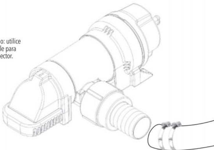
Cuando prepare la embarcación para el invierno, se recomienda quitar la válvula de retención (si se dispone de ella) y desaguar las tuberías para evacuar cualquier agua residual que pueda quedar.
