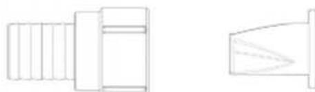
Veuillez noter que le clapet anti-retour NE DOIT PAS être utilisé avec un raccord coudé. Le débit peut être extrêmement réduit si on utilise ensemble un clapet anti-retour et un raccord coudé.
