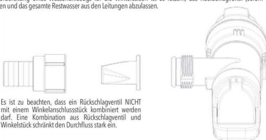
Es ist zu beachten, dass ein Rückschlagventil NICHT mit einem Winkelanschlussstück kombiniert werden darf. Eine Kombination aus Rückschlagventil und Winkelstück schränkt den Durchfluss stark ein.
