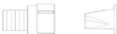
Es ist zu beachten, dass ein Rückschlagventil NICHT mit einem Winkelanschlussstück kombiniert werden darf. Eine Kombination aus Rückschlagventil und Winkelstück schränkt den Durchfluss stark ein.
