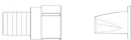
Observera att backventilen INTE ska användas med knärlöret. Kombinationen med backventil och knärlöp begränsar vattenströmningen mycket.
