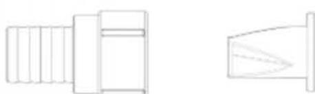
Recuerde que la válvula de retención NO debe usarse con el empalme de codo. La combinación de válvula de retención y codo restringen notablemente el caudal.
