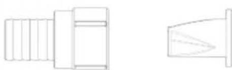
Let op: de regelklep mag NIET gebruikt worden in combinatie met een elleboogfitting. De combinatie van regelklep en elleboog beperken de doorstroming enorm.
