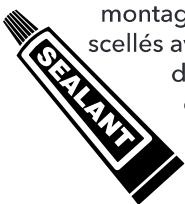
Tous les orifices de montage doivent être scellés avec un produit d'étanchéité de qualité marine pour éviter la pénétration de l'eau.
